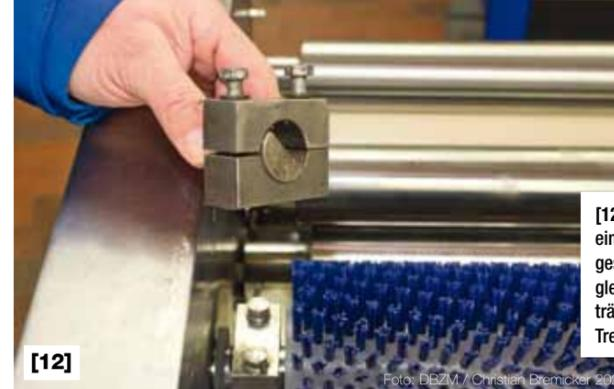
[12] Die Bürstenwalzen sind Verschleißteile, die regelmäßig getauscht werden müssen, um eine einwandfreie Reinigung gewährleisten zu können. Damit dieses Tauschen unkompliziert geschehen kann, sind die Walzen mit Schnellkupplungen versehen. [13] Um die Bleche gleichmäßig zu beölen, dreht sich eine gummierte Walze durch das Trennwachs und überträgt es über den direkten Kontakt auf das Blech. Optional besteht auch die Möglichkeit, das Trennwachs automatisch nachzufüllen.
